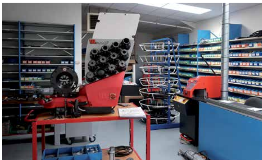
Comme chez Sedimat à St Quentin, la société Lechiffart de Rivery / Amiens possède un local dédié au sertissage des flexibles. Cet atelier comprend tout le nécessaire à cette activité, avec le dévidoir de tuyau, la cisaille pour la mise à dimension du flexible, les jupes et raccords et la sertisseuse (visible au premier plan sur son chariot mobile). Le client arrive avec son modèle et repart avec son produit neuf.
